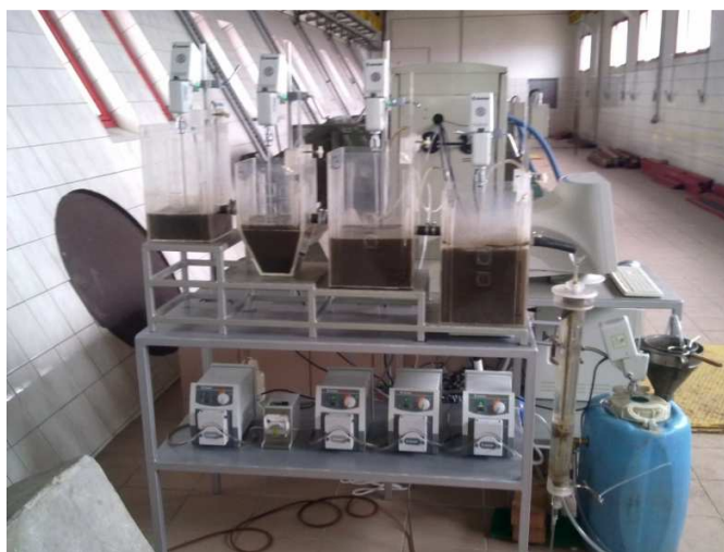
Fot. 2. Zdjęcie przepływowego układu JHB do pomiaru czasu adaptacji osadu do zewnętrznego źródła węgla w trakcie badań w oczyszczalni „Wschód” w Gdańsku.
