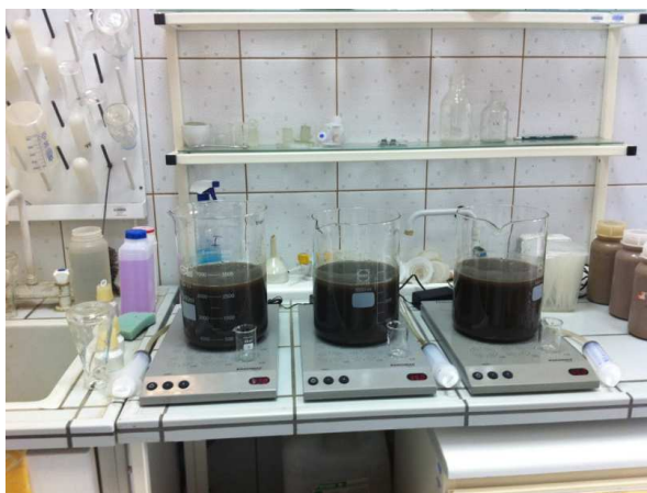
Fot. 1. Trzy równoległe stanowiska badawcze do pomiaru szybkości denitryfikacji
