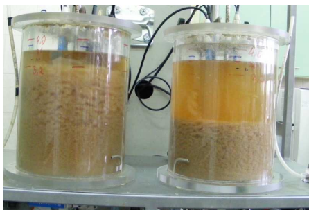
a) RI z dodatkiem etanolu jako zewnętrznego źródła węgla b) RI z dodatkiem olejów fuzlowych jako zewnętrznego źródła węgla
