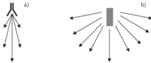
Rys. 2. Ilustracja graficzna anteny wytwarzającej: a) promieniowanie skupione na wybranym kierunku oraz b) promieniowanie bardziej rozproszone
