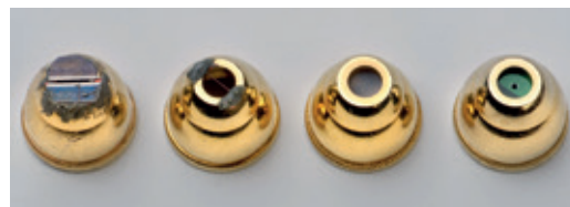
Rys. 17. Zdjęcie końcówek lasera półprzewodnikowego, na których znajdują się od lewej: szczelinka, drucik, tkanina, otworek
