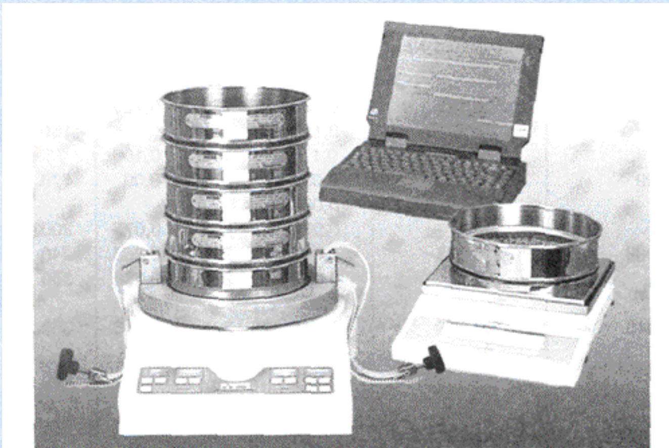
Rysunek 3.6. Sita z automatycznym frakcjonowaniem proszku [22]
